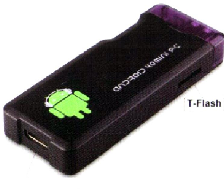
A/V изход: HDMI изход за свързване с HD телевизор
